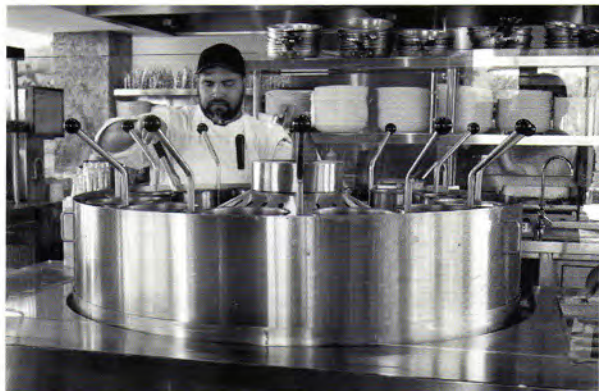
パテントを取得した同店が誇る自動ゆで麺機がキッチンメイン部分に据えられる。12のバスタかごを装備し、乾麺から茹で上げて10分で90食の能力を有するという。
